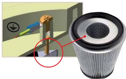
Inovativni sistem filtriranja TECNO R-evolution jedinica centralnog usisivača se sastoji od konusnog filtera, izrađenog od poliestera i aluminijumskih vlakana, koji se mogu prati, i certifikovane klase M, spojeni sa uzemljenjem Sistema. Iz ovih razloga filter omogućuje gubitak statičkog naboja, i dozvoljava prašini da pada direktno u kantu, zahvaljujući još i konusnom obliku.
